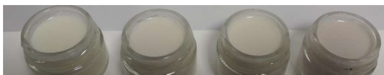
Εικόνα 1. Γυάλινοι κυλινδρικοί περιέκτες των 30 ml με περιεκτικότητες οινολάσπης από αριστερά προς τα δεξιά: 0% w/w, 0,5% w/w, 1% w/w και 2% w/w
