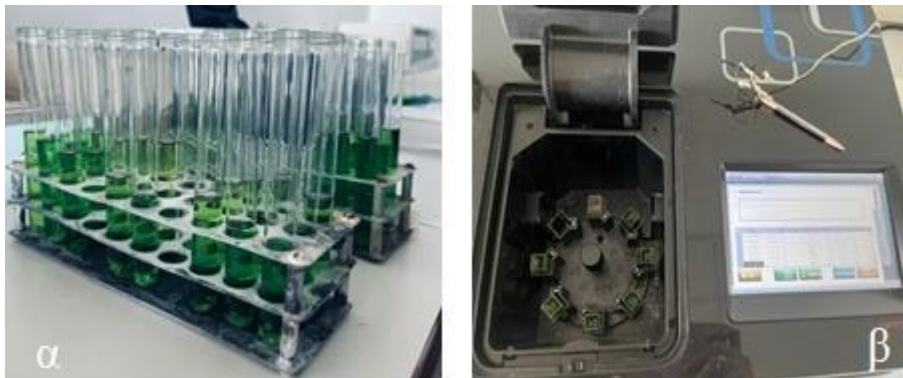
Εικόνα 2.4: α) Φυτικό εκχύλισμα αιθανόλης για ποσοτικό προσδιορισμό χλωροφύλλης και καροτενοειδών, β) Εκτίμηση της απορρόφησης στο φασματοφωτόμετρο.
