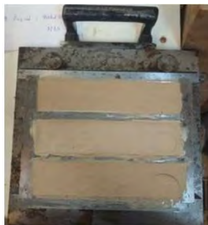
Σχήμα 12. Εφαρμογή κονιάματος σε μήτρα
