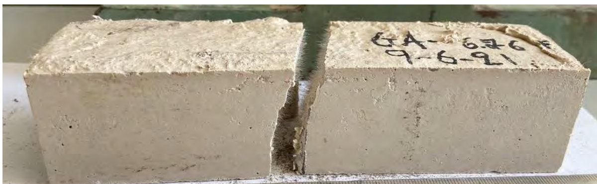
Σχήμα 34. GA-6.2-6F μετά από την δοκιμή του σε κάμψη
