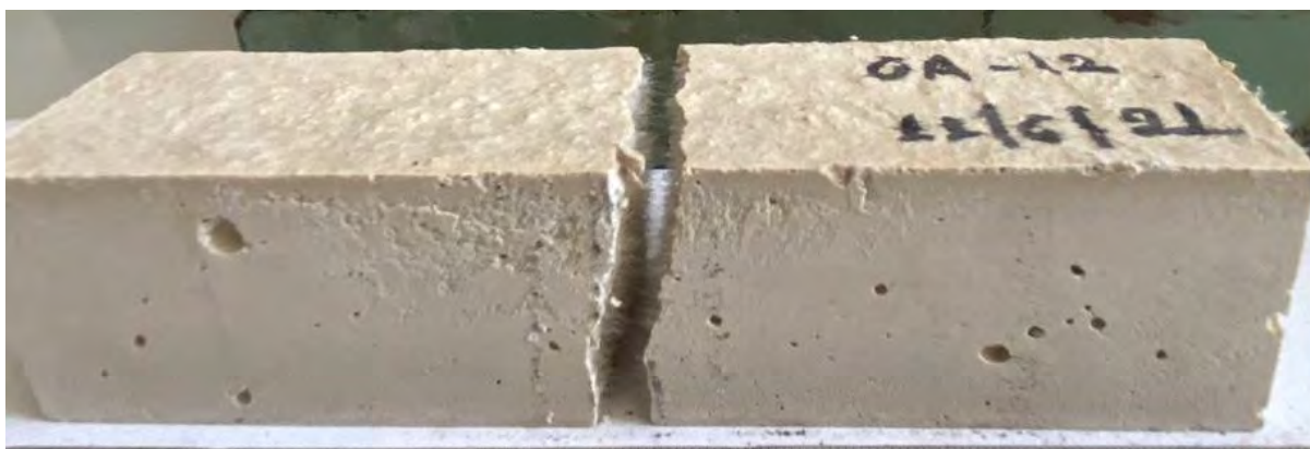
Σχήμα 22. Δοκίμιο μετά από κάμψη GA-12
