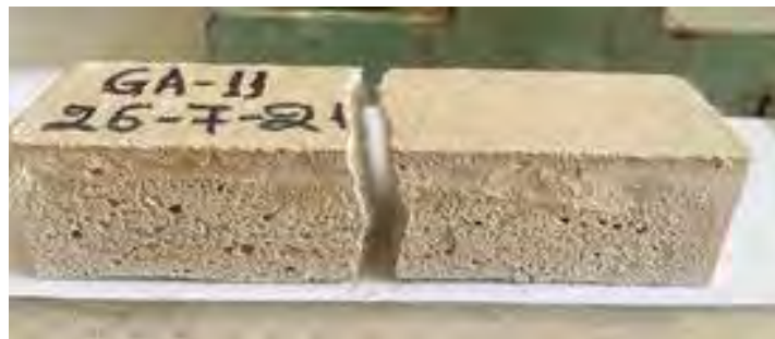
Σχήμα 27. Τα δοκίμια του μίγματος GA-11 μετά από την δοκιμή τους σε κάμψη
