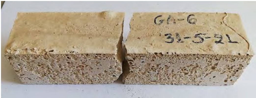
Σχήμα 32. Κονίαμα GA-6 έπειτα από δοκιμή σε κάμψη
