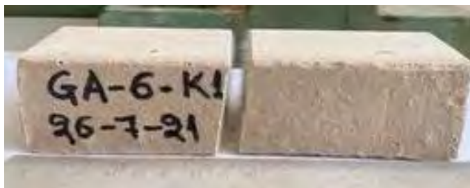
Σχήμα 29. Τα δοκίμια του μίγματος GA-6-K1 μετά από την δοκιμή τους σε κάμψη
