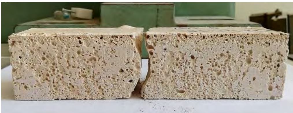
Σχήμα 29. Κονίαμα GA-6 έπειτα από δοκιμή σε κάμψη
