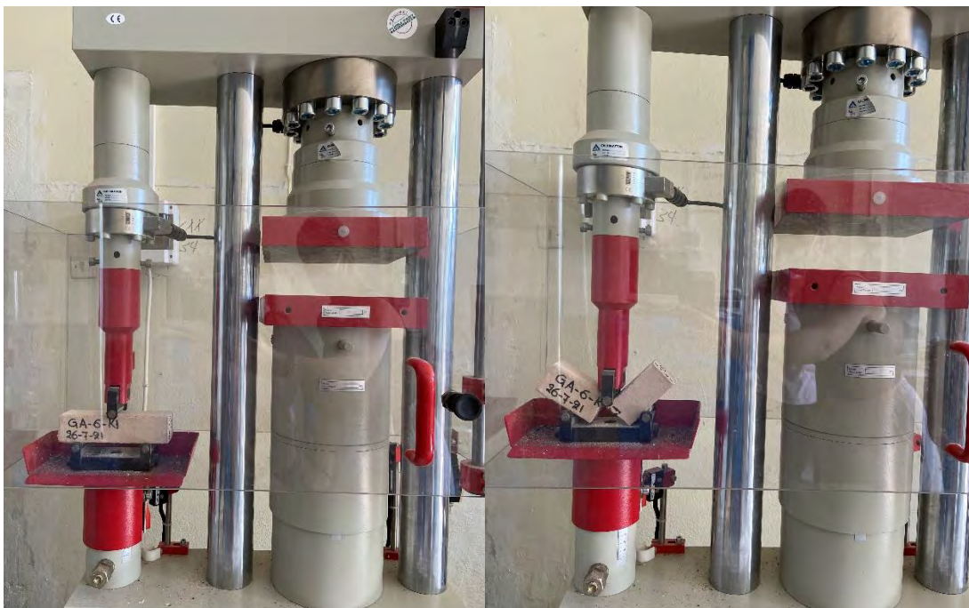
Σχήμα 13. Δοκιμή σε κάμψη τριών σημείων
