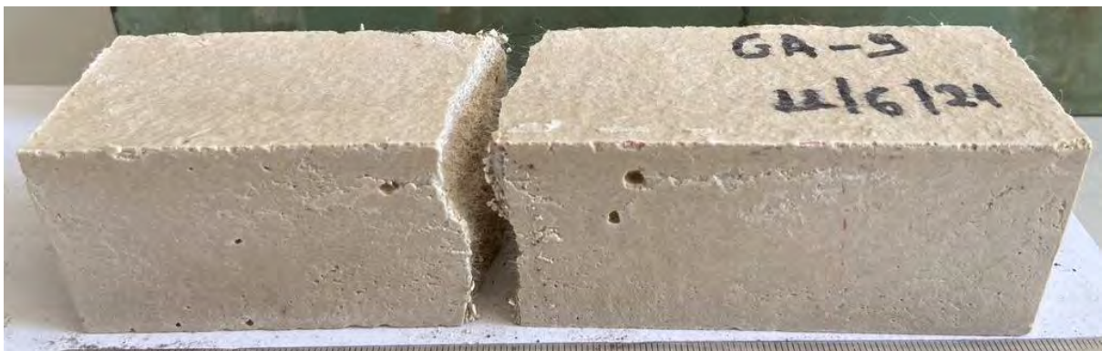
Σχήμα 21. Δοκίμιο μετά από κάμψη GA-9
