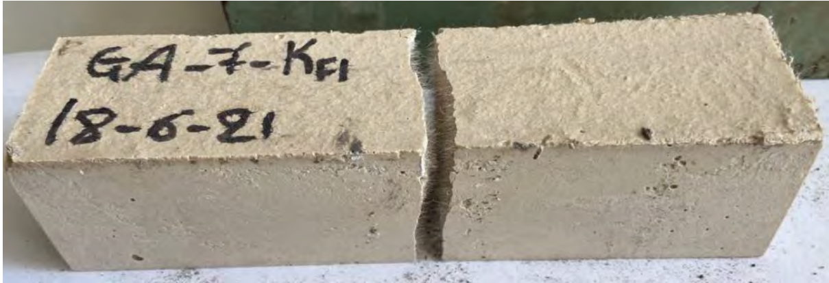
Σχήμα 20. Δοκίμιο μετά από κάμψη GA-7-KFl
