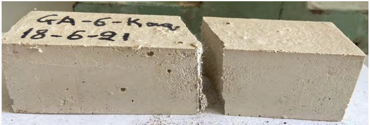
Σχήμα 36. GA-6- Καα μετά από την δοκιμή του σε κάμψη
