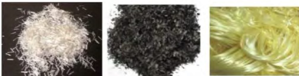
Σχήμα 1. Τύποι ινών α) γυαλιού, β) άνθρακα, γ) αραμιδίου
