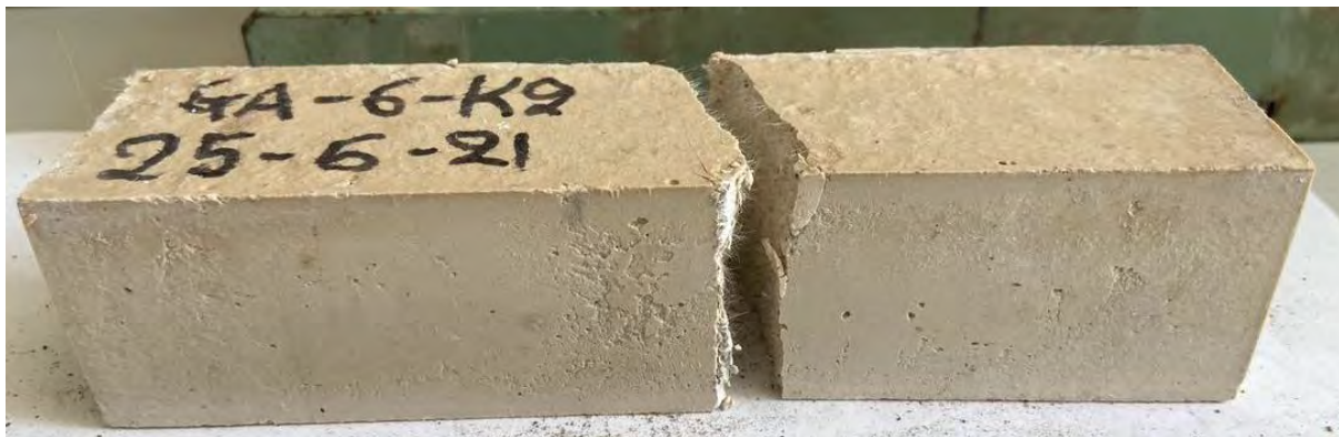
Σχήμα 38. Κονίαμα GA-6-K2 μετά την δοκιμή σε κάμψη
