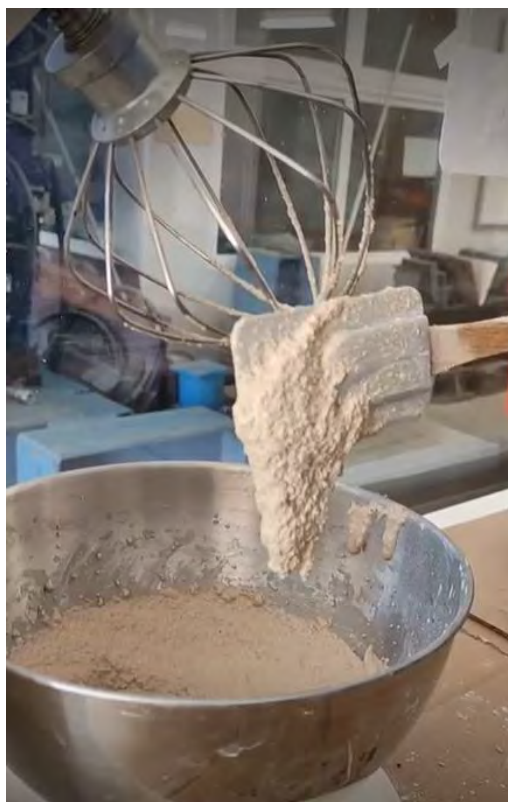
Σχήμα 7. Ανάμειξη μίγματος γεωπολυμερούς
