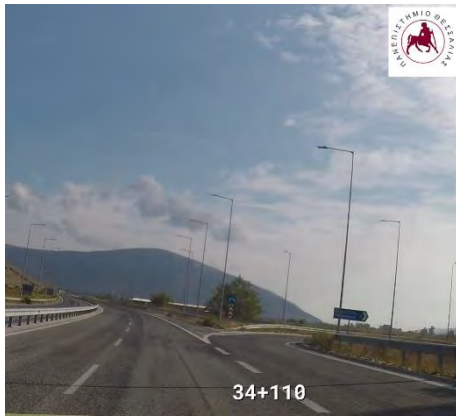
Χ.Θ. : 34+110 : Απαιτείται η τοποθέτηση Σ.Α.Ε.Π. & ευανάγνωστη σήμανση
