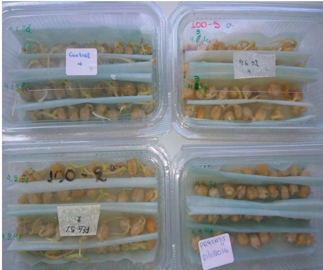
Εικόνα 4: Απόθεση Σπόρων μέσα σε κουτιά με διηθητικό χαρτί ποτισμένο με μυκητοκτόνο και PEG 6000.
