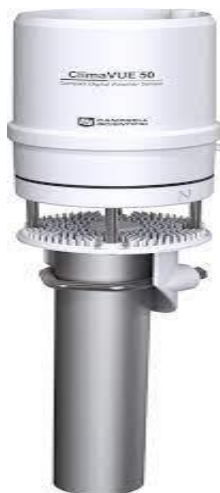
Εικόνα 1.6: Ο αισθητήρας ατμοσφαιρικής υγρασίας 'ClimaVUE50'.
