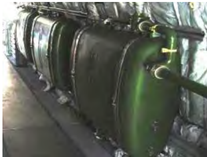
Εικόνα 17.α: Δεξαμενή και σωληνώσεις επιβραδυντικού υγρού (32)
