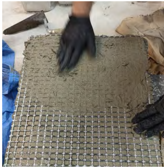
Σχήμα 2.5: Ενίσχυση τοιχίσκου με εμπότιση υαλοπλέγματος σε τσιμεντοκονίαμα.
