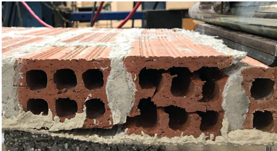
Σχήμα 4.3: Εικόνα αστοχίας του δοκιμίου "OOP_WALL_GEO-B2".
