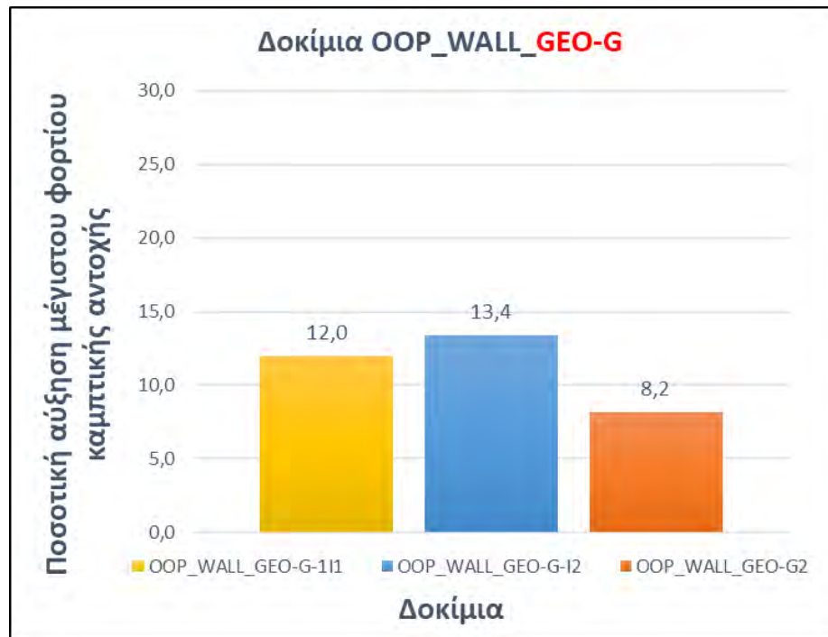
Σχήμα 4.30: Ραβδόγραμμα αύξησης μέγιστου φορτίου καμπτικής αντοχής των δοκιμών "OOP_WALL_GEO-G".
