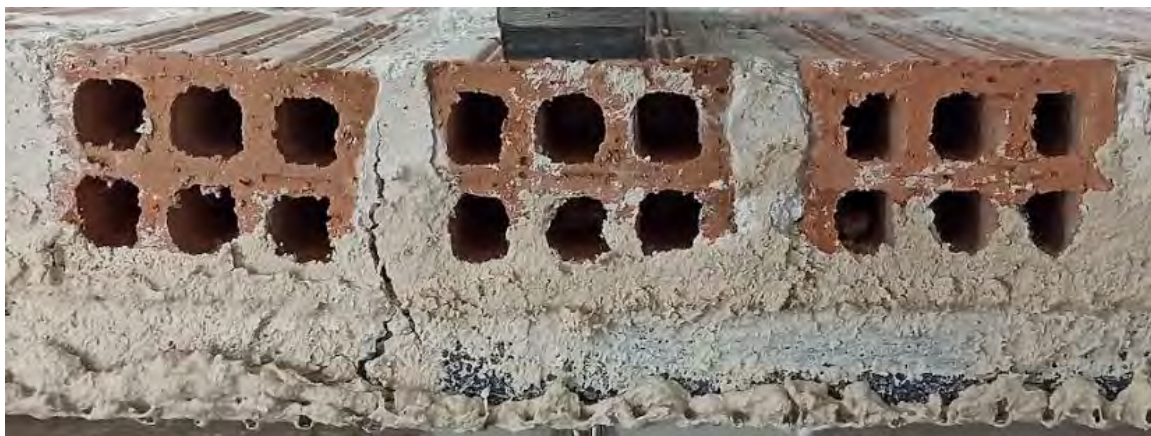
Σχήμα 4.18: Εικόνα αστοχίας του δοκιμίου "OOP_WALL_GEO-G-111".
