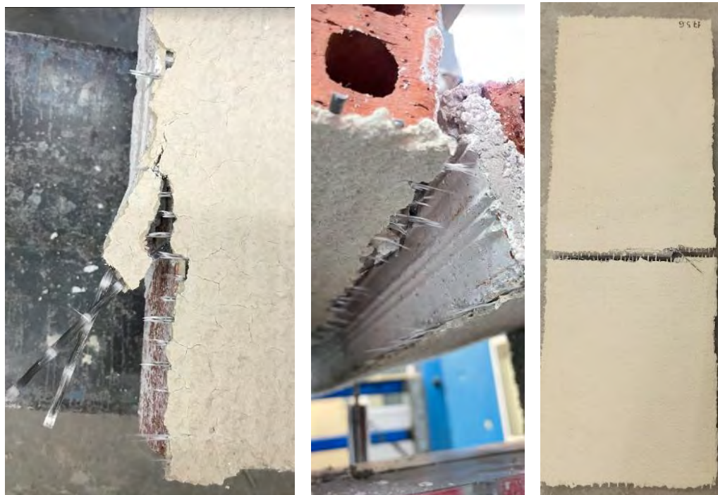
Σχήμα 4.5: Θραύση ινών του υαλοπλέγματος του δοκιμίου "OOP_WALL_GEO-G2".
