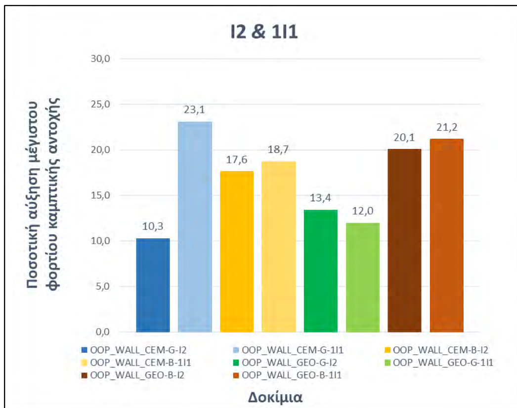
Σχήμα 4.33: Συγκριτικό ραβδόγραμμα αύξησης μέγιστου φορτίου καμπτικής αντοχής των δοκιμών με διάταξη θερμομόνωσης I2 και 111.
