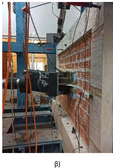
Σχήμα 3.19: Η πειραματική διάταξη για τη φόρτιση του (FRAME_1): α) πρόσοψη; β) πλάγια όψη.
