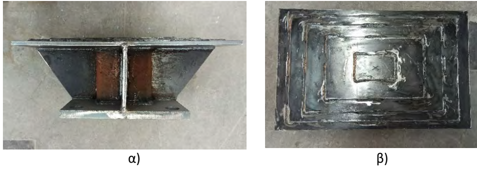
Σχήμα 3.18: Μεταλλική κυρτή επιφάνεια επιβολής φορτίου: α) πλάγια όψη; β) κάτοψη.
