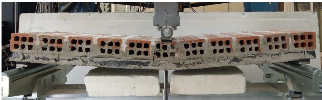
Σχήμα 4.13: Εικόνα αστοχίας του δοκιμίου "OOP_WALL_CEM-B-I2".
