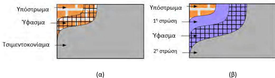
Σχήμα 2.20: Τοποθετήσεις υφάσματος: α) απευθείας και β) «sandwich» (Sagar et al., 2019).
