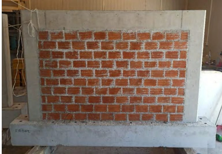
Σχήμα 3.17: Τοιχοπληρωμένο πλαίσιο (FRAME_1).
