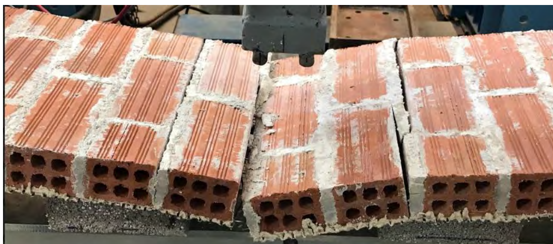
Σχήμα 4.4: Εικόνα αστοχίας του δοκιμίου "OOP_WALL_GEO-G2".
