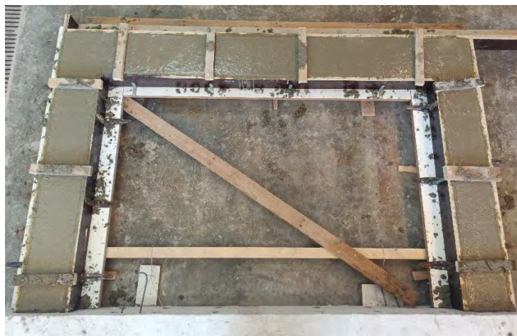
Σχήμα 3.16: Κατασκευή πλαισίων: α) τοποθέτηση οπλισμού εντός των καλουπιών; β) σκυροδέτηση πλαισίου.
