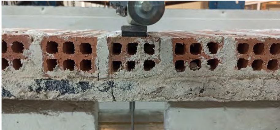
Σχήμα 4.12: Καμπτική ρηγμάτωση του "OOP_WALL_GEO-G-I2".
