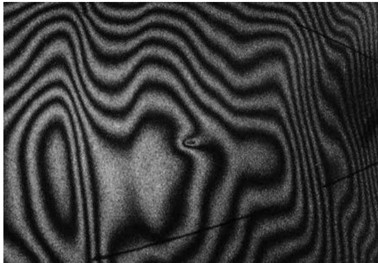
Σχήμα 4.5 Συμβολόγραμμα Δοχείου Πίεσης. Η ανομοιογένεια στο κέντρο της εικόνας εντοπίζει ατέλεια στο κέλυφος του δοχείου
