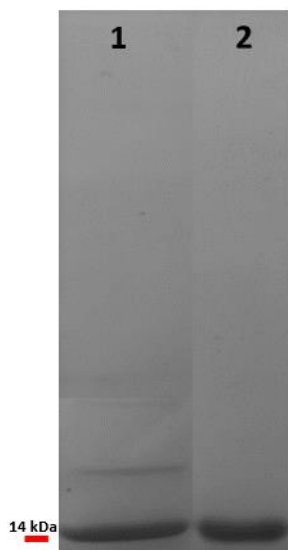
Εικόνα 70: Πηκτή 12 % SDS πολυακρυλαμιδίου, με χρώση Coomassie brilliant blue R-250. Στη διαδρομή 1 απεικονίζεται το πρωτεϊνικό κλάσμα, μετά τη στήλη SPFF, ενώ στη διαδρομή 2 απεικονίζεται το πρωτεϊνικό κλάσμα, μετά τη στήλη Resource RPC18.
