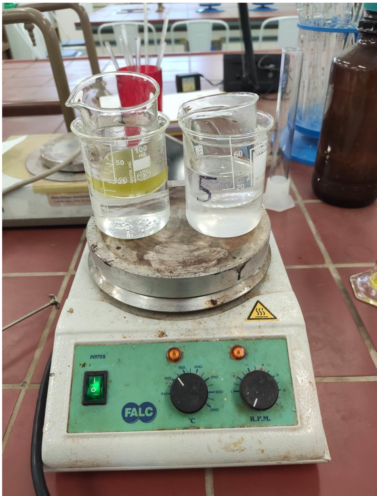
Εικόνα 12 Υδατική και ελαιώδης φάση στο υδατόλουτρο πάνω στην εστία θέρμανσης
