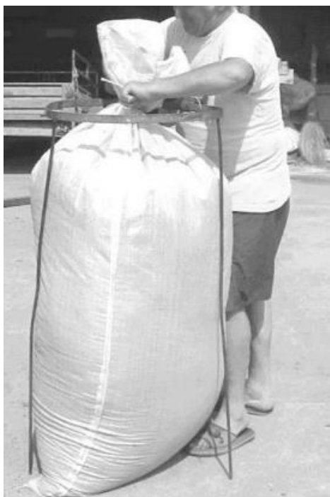
Εικόνα 3.14: Απλό, αυτοδημιούργητο πλαίσιο σαν βοηθητικός εξοπλισμός πλήρωσης σάκων (Öztekin και Martinov, 2007)
