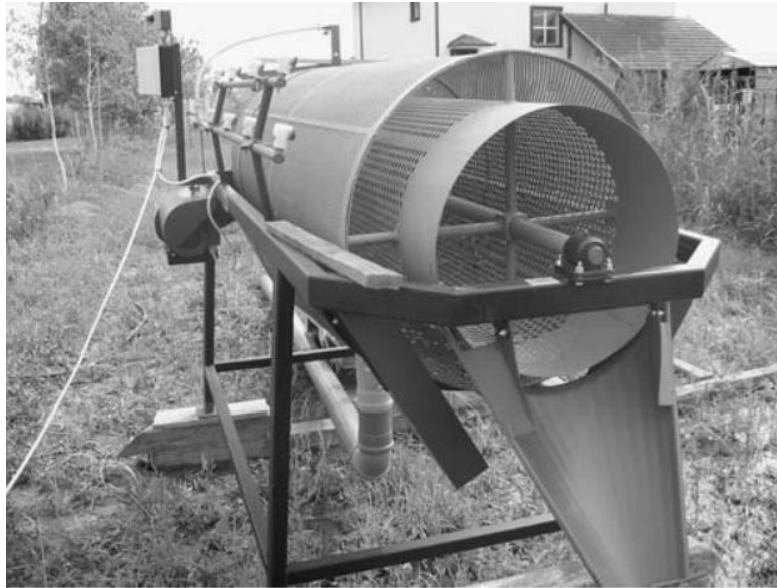
Εικόνα 2.4: Πλυντήριο δύο τυμπάνων και δύο σειρών ακροφύσιων ειδικά σχεδιασμένο για την έκπλυση σπόρων κολοκύθας (Öztekin και Martinov, 2007)
