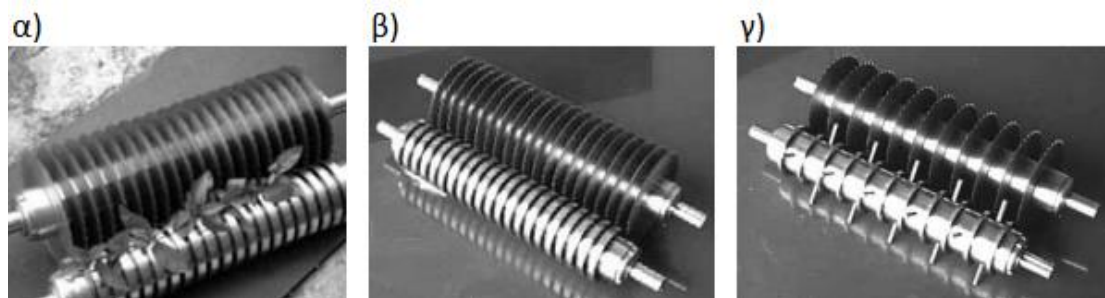
Εικόνα 3.4: Ειδική δικύλινδρη συσκευή κοπής για αρωματικά και φαρμακευτικά φυτά με α) τη λειτουργία να αποτελούν ο κύλινδρος με δίσκους κοπής (πάνω) και ο λείος κύλινδρος με τις κάθετες αυλακώσεις (κάτω) και το σετ κυλίνδρου κοπής να έχει ένα μήκος β) 20 mm και γ) 40 mm (Öztekin και Martinov, 2007)
