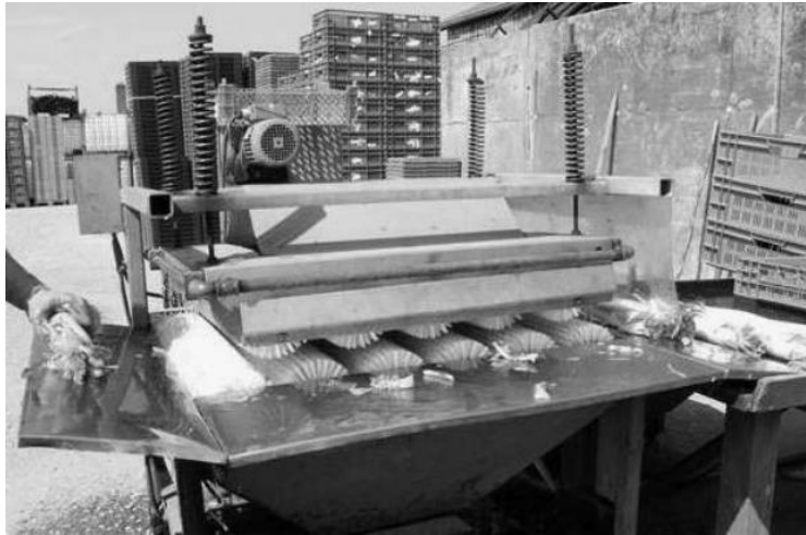
Εικόνα 2.5: Πλυντήριο με βούρτσες για την έκπλυση των ριζών αρωματικών και φαρμακευτικών φυτών (Öztekin και Martinov, 2007)
