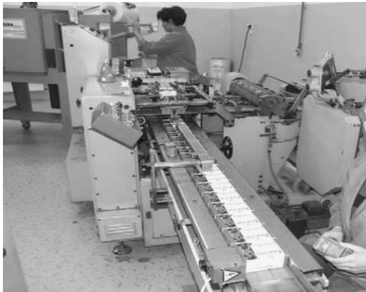
Εικόνα 3.17: Κλείσιμο των κουτιών τσαγιού και το τύλιγμα των κουτιών (Öztekin και Martinov, 2007)
