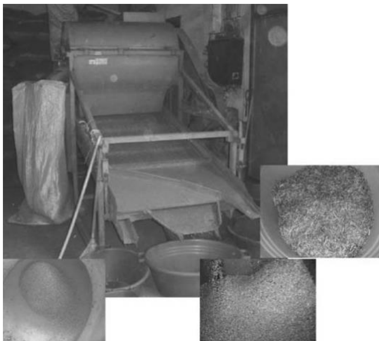
Εικόνα 3.6: Μηχανή σύνθλιψης αξονικού τύπου και αποτελέσματα από την επεξεργασία μέντας (Öztekin και Martinov, 2007)
