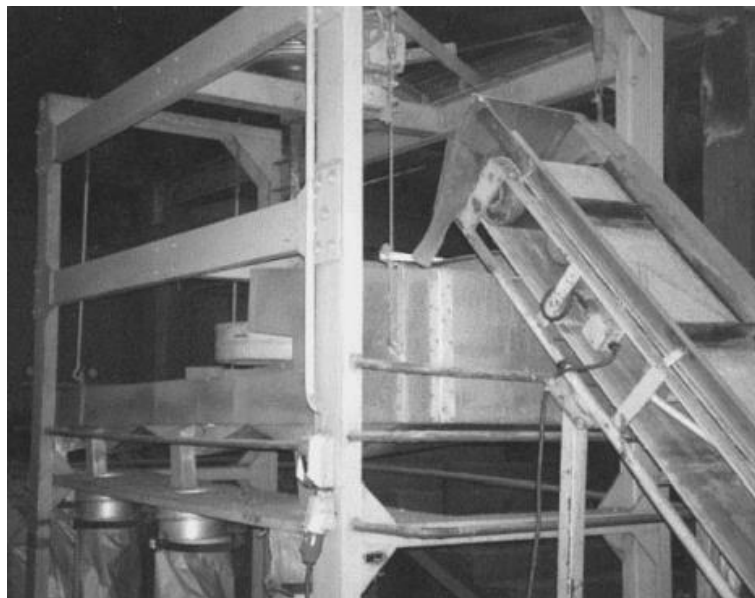
Εικόνα 3.10: Διαθέσιμη στην αγορά μηχανή με στρογγυλά κόσκινα και χαλύβδινα καλώδια για τη σύνδεση του περιβλήματος των κόσκινων με το πλαίσιο (Öztekin και Martinov, 2007)
