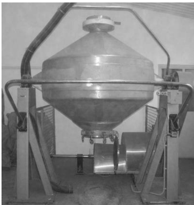
Εικόνα 3.15: Συσκευή ανάμιξης αρωματικών και φαρμακευτικών φυτών με ειδικό δοχείο (Öztekın και Martinov, 2007)
