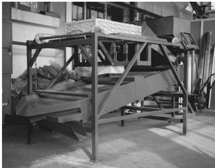
Εικόνα 3.8: Διαθέσιμο στην αγορά κόσκινο με οριζόντιο έκκεντρο μηχανισμό (Öztekin και Martinov, 2007)
