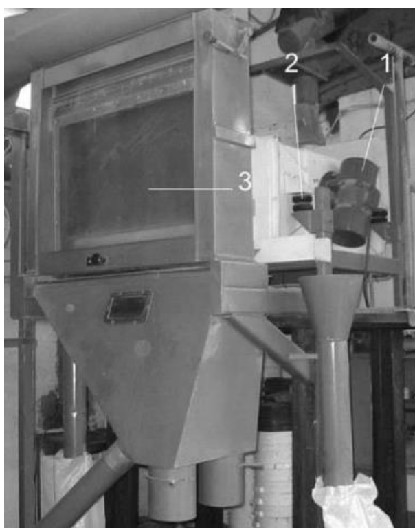
Εικόνα 3.9: Διαθέσιμο στην αγορά κόσκινο με δύο πλευρικές γεννήτριες ταλαντώσεων (Öztekın και Martinov, 2007)
