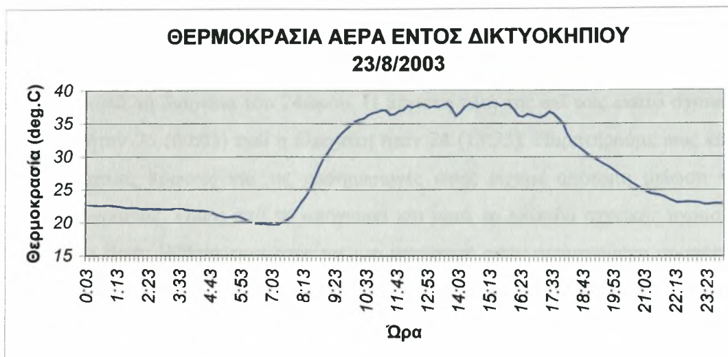
Σχήμα 3.7: Ημερήσια διακύμανση θερμοκρασίας εντός του δικτυοκηπίου
