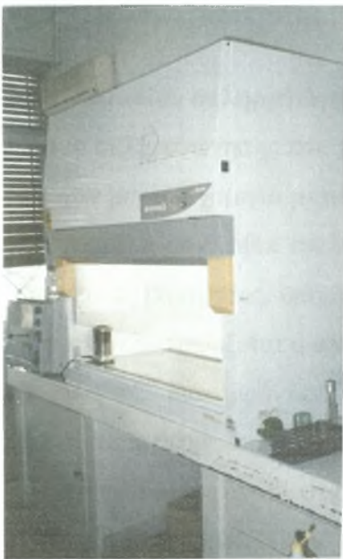
Εικόνα 2.2 Τράπεζα νηματικής ροής
