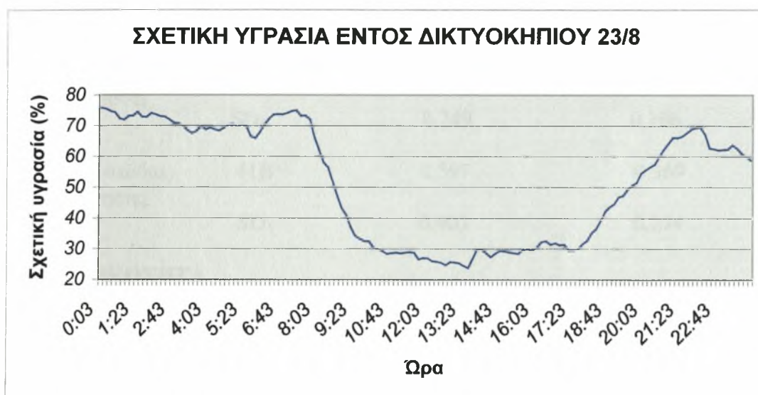
Σχήμα 3.9: Ημερήσια διακύμανση σχετικής υγρασίας εντός του δικτυοκηπίου.
