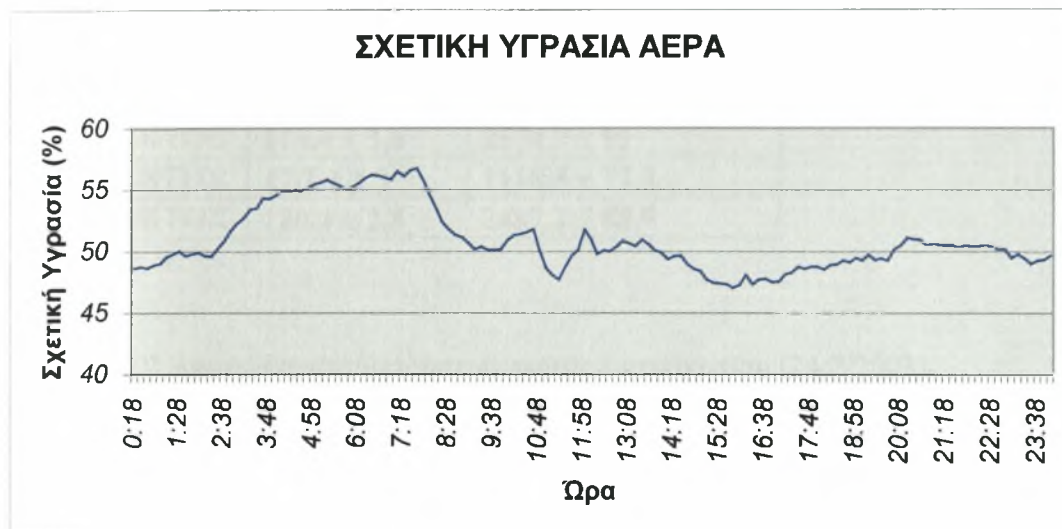
Σχήμα 3.5: Ημερήσια διακύμανση σχετικής υγρασίας αέρα στο θάλαμο 2 ου σταδίου σκληραγωγησης.
