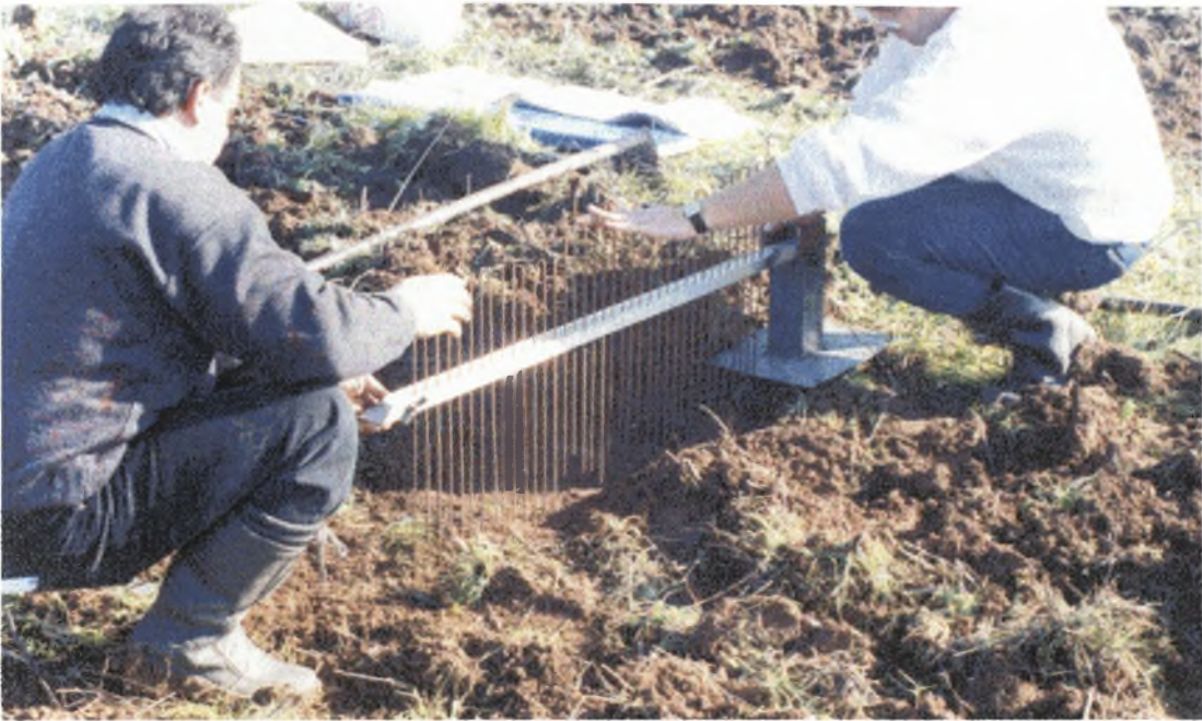
Σχήμα 13. Όργανα μέτρησης βάθους κατεργασίας δισκοσβάρνας.
