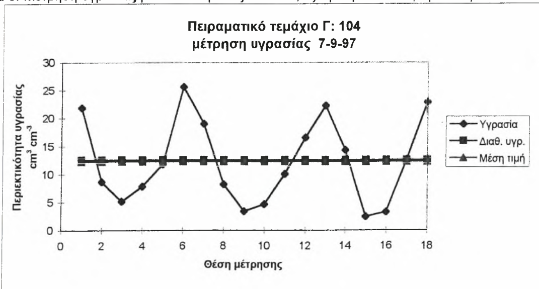
Σχήμα 9. Μέτρηση υγρασίας με TDR σε βάθος 20 cm, εξάτμιση 47.6 mm, άρδευση 5-9-97
