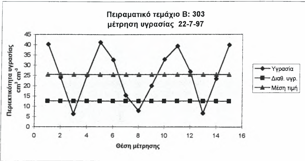
Σχήμα 28. Μέτρηση υγρασίας με TDR σε βάθος 15 cm, εξάτμιση 33.1 mm, άρδευση 22-7-97
