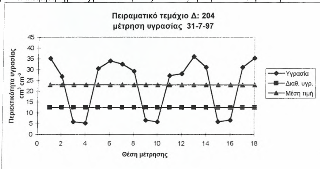
Σχήμα 11. Μέτρηση υγρασίας με TDR σε βάθος 16.5 cm, εξάτμιση 35.8 mm, άρδευση 30-7-97
