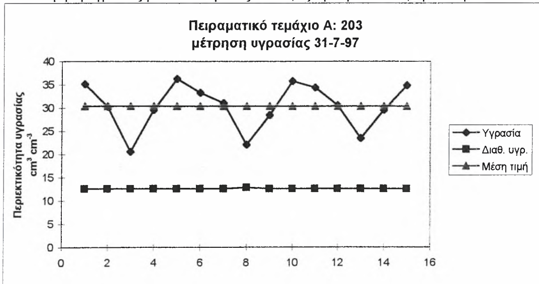
Σχήμα 14. Μέτρηση υγρασίας με TDR σε βάθος 16.5 cm, εξάτμιση 35.8 mm, άρδευση 30-7-97
