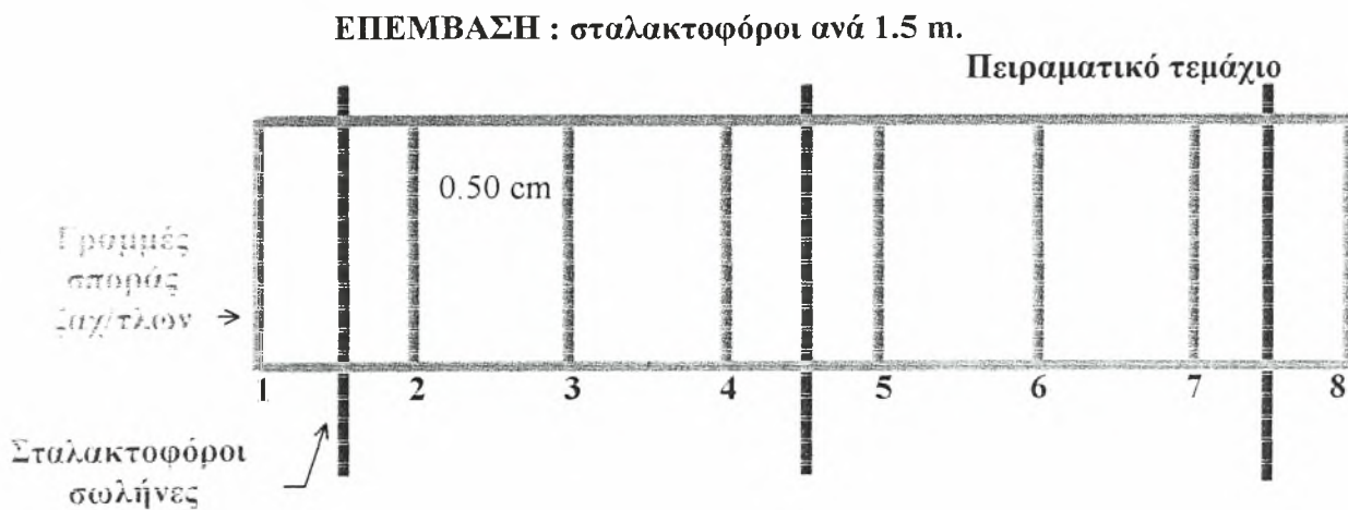
ΣΧΗΜΑ 4. 3. Διάταξη σταλακτηφόρων σωλήνων ανά πειραματική επέμβαση
