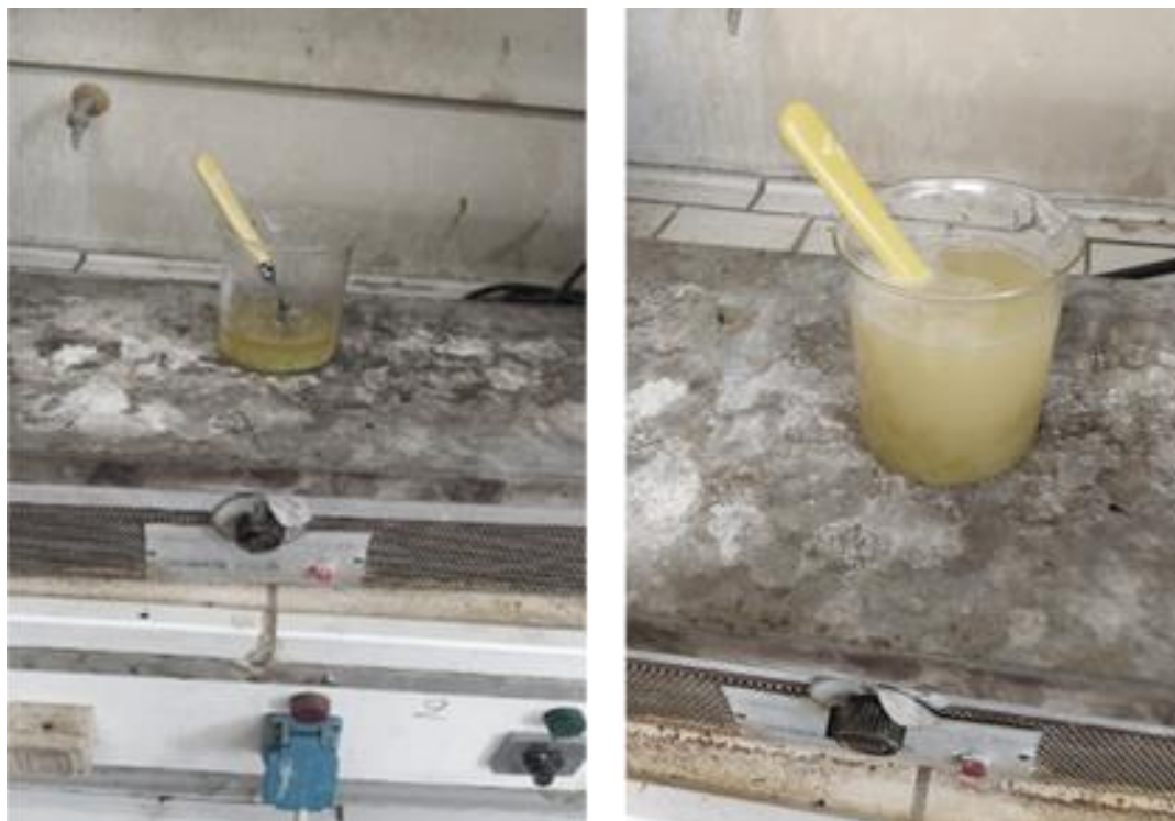
Εικόνα 19. Τελικό ποτήρι ζέσεως T στην θερμαινόμενη πλάκα των 70 °C το οποίο περιέχει το περιεχόμενο από το ποτήρι A , B και Γ .
