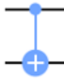
Σχήμα: 27 – Σύμβολο κβαντικής πύλης CNOT
