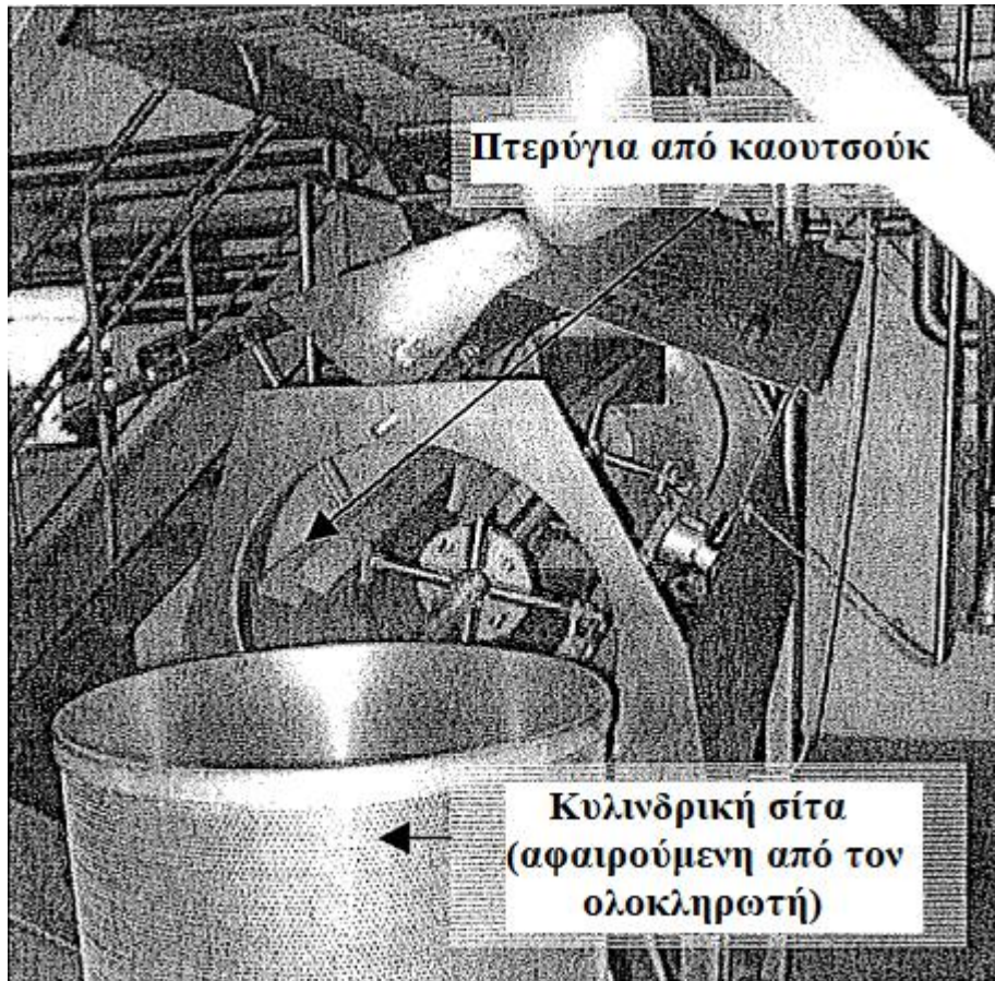
Σχήμα 3.10. Ένας ολοκληρωτής με το κυλινδρικό πλέγμα να έχει αφαιρεθεί για να είναι ορατά τα πτερύγια από καουτσούκ για το διαχωρισμό σπόρων/πολτού
