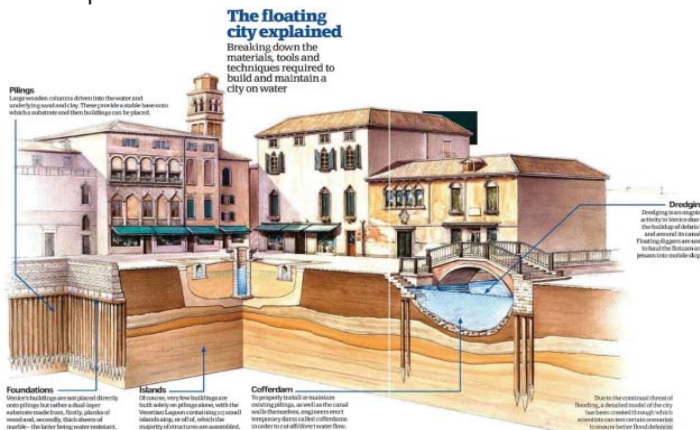
Εικόνα 2.5. Πασσαλοπηξία στην Βενετία και θεμέλια
