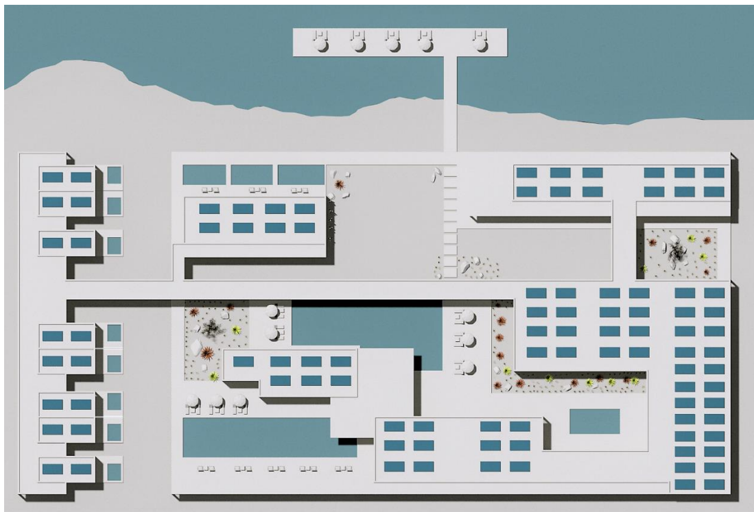
Άνωψη δώματος με ενδεικτική τοποθέτηση φωτοβολταϊκών πάνελ
