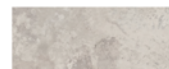
ΑΔΡΗ ΟΨΗ I (ώχρα με έντονα νερά) - όλες οι εξωτερικές επιφάνειες του παλιού κτιρίου
