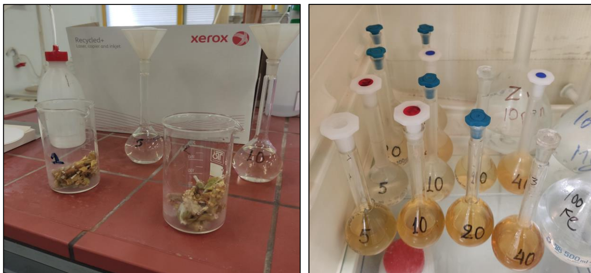
Εικόνα 11. Οι ογκομετρικές φιάλες με το διηθητικό χαρτί και η τοποθέτησή τους στο ψυγείο
