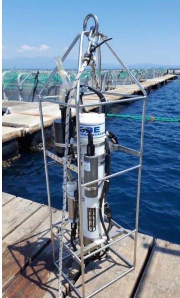
Εικόνα 2.2: Αυτογραφικό όργανο καταγραφής φυσικοχημικών χαρακτηριστικών του νερού της εταιρείας Sea Bird Electronics.
