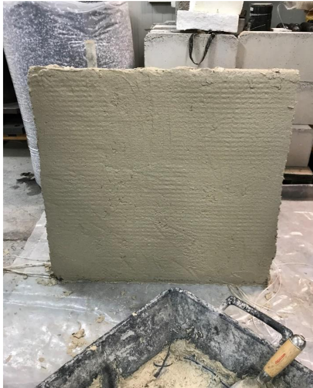
Σχήμα 3.14: Ενισχυμένο δοκίμιο τοιχοπλήρωσης
