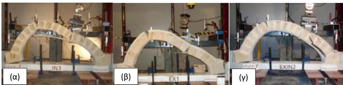
Σχήμα 2.15: Μορφές αστοχίας (α) ενισχυμένου δοκιμίου στην κάτω παρειά, (β) ενισχυμένου δοκιμίου στην άνω παρειά, (γ) αμφίπλευρα ενισχυμένου δοκιμίου (Leire Garmendia et al., 2014)
