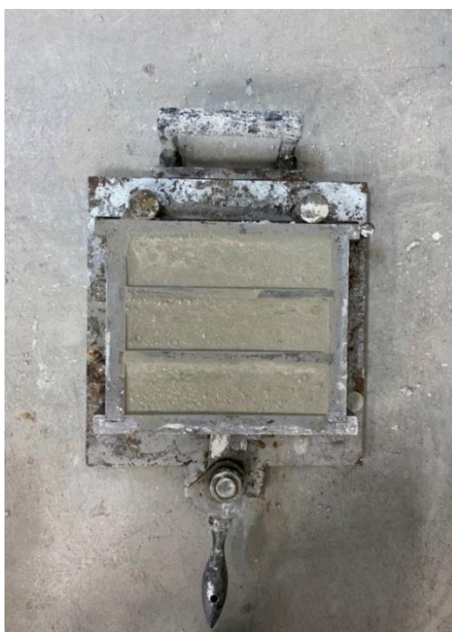
Σχήμα 3.5: Τοποθέτηση κονιάματος στη μεταλλική μήτρα
