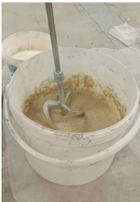
Σχήμα 3.12: Κονίαμα γεωπολυμερούς κατά τη φάση της ανάμειξης
