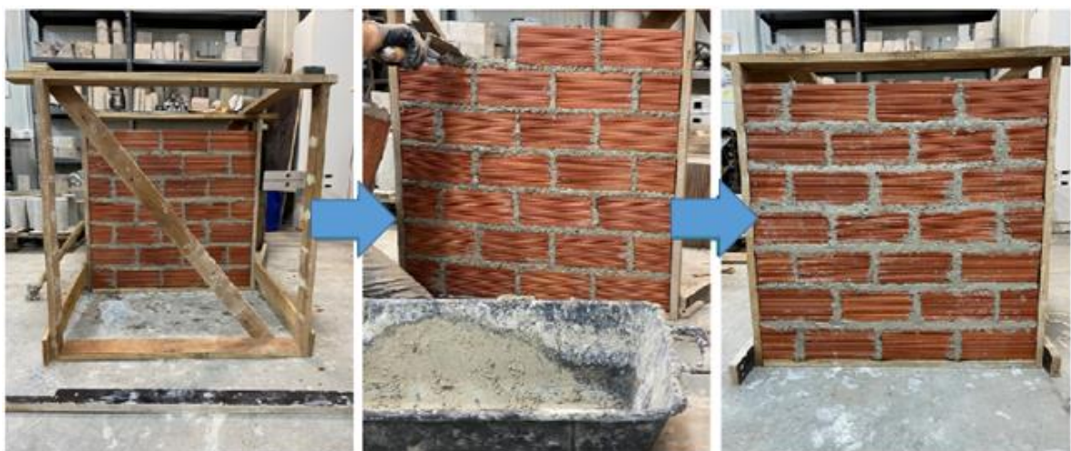
Σχήμα 3.10: Διαδικασία κατασκευής δοκιμών τοιχοπλήρωσης
