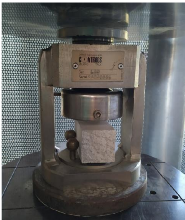
Σχήμα 3.7: Πειραματική διάταξη δοκιμής θλίψης πρίσματος του κονιάματος
