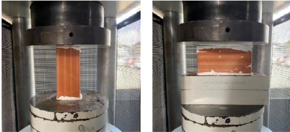
Σχήμα 3.3: Δοκιμή μονοαξονικής θλίψης μεμονωμένων οπτόπλινθων
