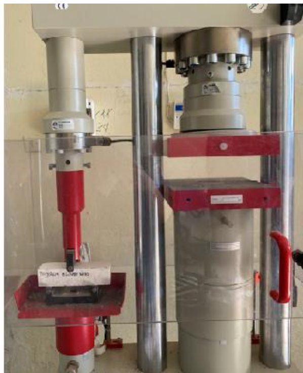
Σχήμα 3.6: Πειραματική διάταξη δοκιμής κάμψης τριών σημείων κονιάματος
