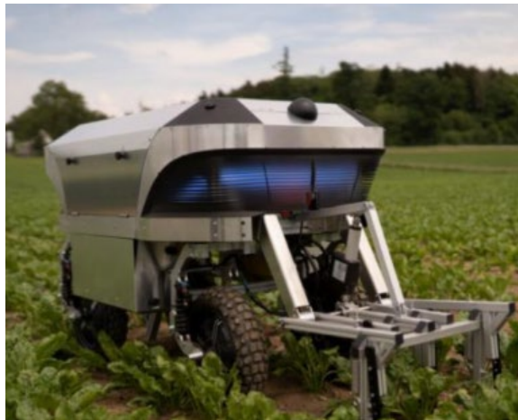
Σχήμα 8 Αγροτικό Ρομποτικό σύστημα απομάκρυνσης ζιζανίων.
