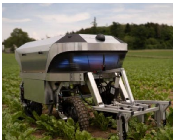
Σχήμα 8 Αγροτικό Ρομποτικό σύστημα απομάκρυνσης ζιζανίων.
