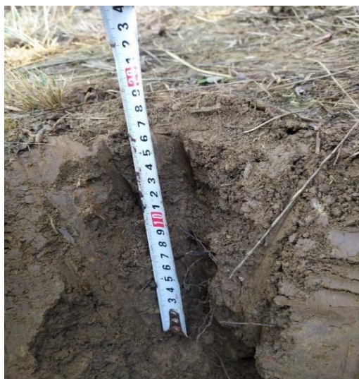
Εικόνες 3-4: Εδαφικές τομές για μακροσκοπική μέτρηση υγρασίας των μπεκ (αριστερά) και στάγδην (δεξιά) συστημάτων άρδευσης μία ημέρα μετά την άρδευση.
