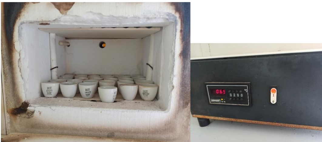
Εικόνα 10: Θερμοθάλαμος με κάψες και θερμοστάτης
