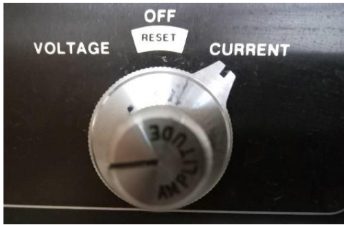
Εικόνα 4.6: Διακόπτης ρύθμισης λειτουργίας σε τάση ή ένταση ρεύματος
