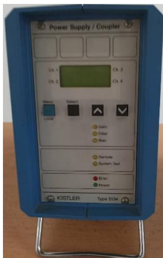
Εικόνα 3.2: Kistler power supply/coupler
