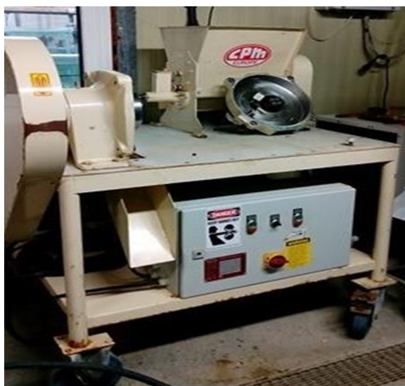
Εικόνα 2.2. Πελλετομηχανή τύπου California Pellet Mill.
