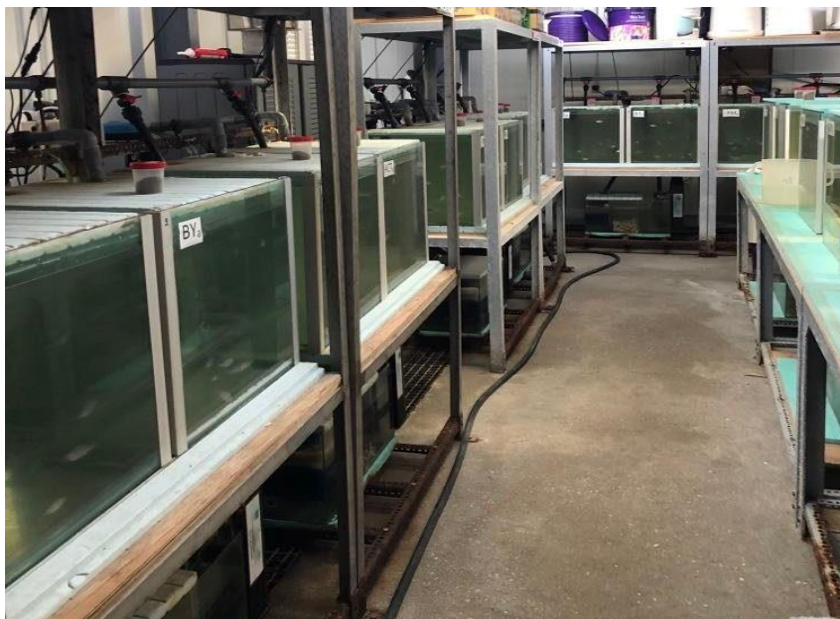
Εικόνα 2.1. Άποψη δεξαμενών κλειστού κυκλώματος κυκλοφορίας θαλασσινού νερού Πανεπιστημίου Θεσσαλίας (προσωπικό αρχείο συγγραφέα).
