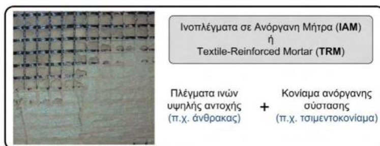
Σχήμα 1.1 Περιγραφή του σύνθετου υλικού ενίσχυσης που ονομάζεται Ινοπλέγματα σε Ανόργανη Μήτρα (IAM). (Κούτας, 2015)
