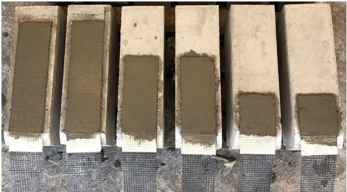
Σχήμα 4.12 Η τελική μορφή όλων των ενισχυμένων δοκιμίων με δύο στρώσεις IAM για μήκη συνάφειας 300mm, 200mm και 100mm.
