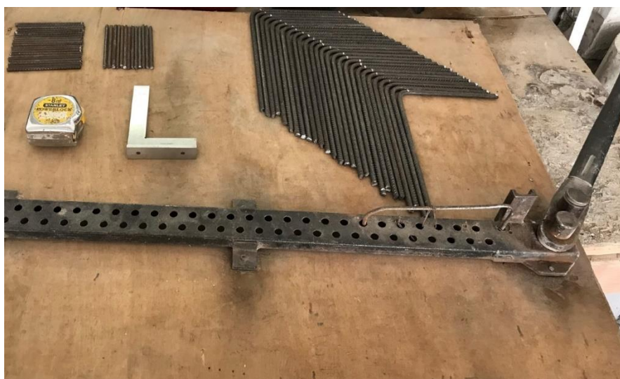
Σχήμα 4.4 Κουρμπαδόρος μαζί με ράβδους Φ8 και Φ6.
