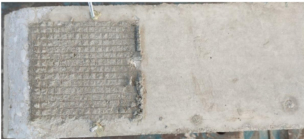
Σχήμα 4.23 Διαστρωματική αποκόλληση μεταξύ πλέγματος και κονιάματος για το δοκίμιο L100_2_2 α) και β).
