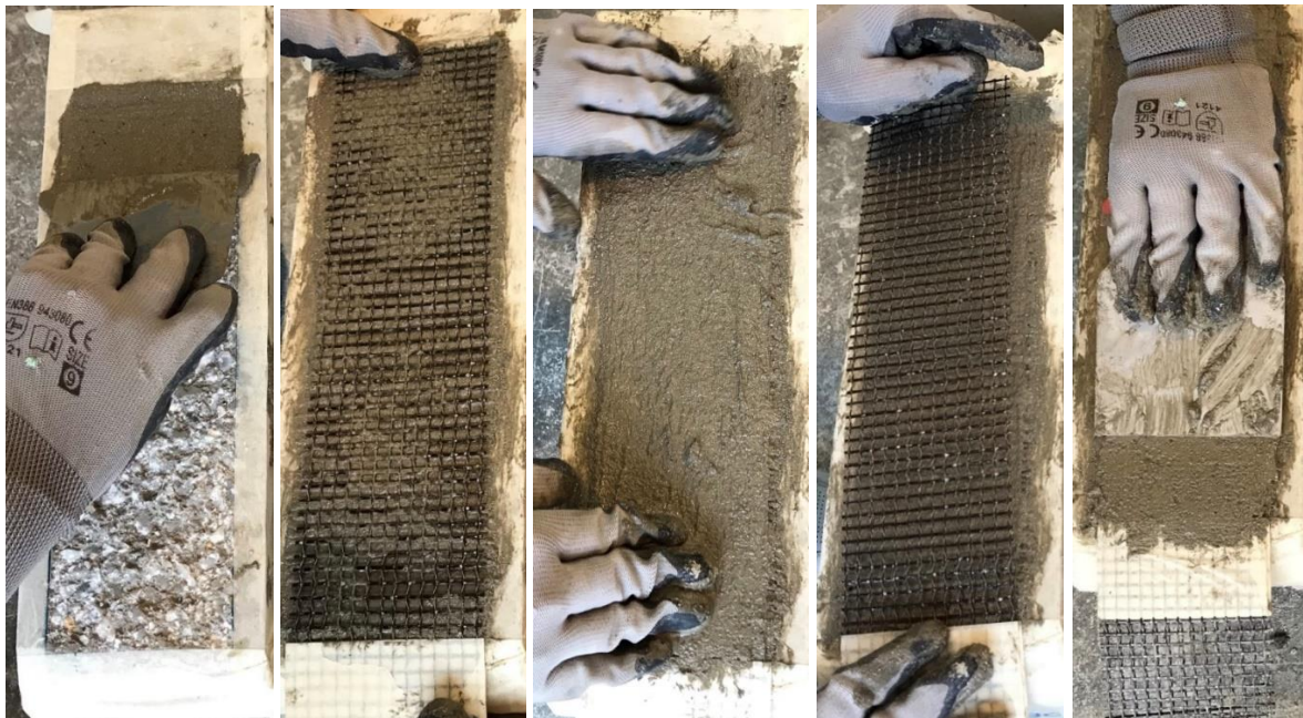
Σχήμα 4.11 Διαδικασία ενίσχυσης: α) τοποθέτηση 1 ης στρώσης κονιάματος, β) τοποθέτηση 1 ης στρώσης ινοπλέγματος, γ) τοποθέτηση 2 ης στρώσης κονιάματος, δ) τοποθέτηση 3 ης στρώσης ινοπλέγματος, ε) τοποθέτηση τελικής στρώσης κονιάματος
