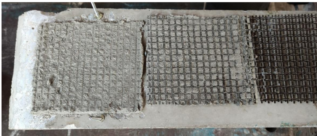
Σχήμα 4.22 Διαστρωματική αποκόλληση μεταξύ πλέγματος και κονιάματος για το δοκίμιο L100_2_1 α) και β).
