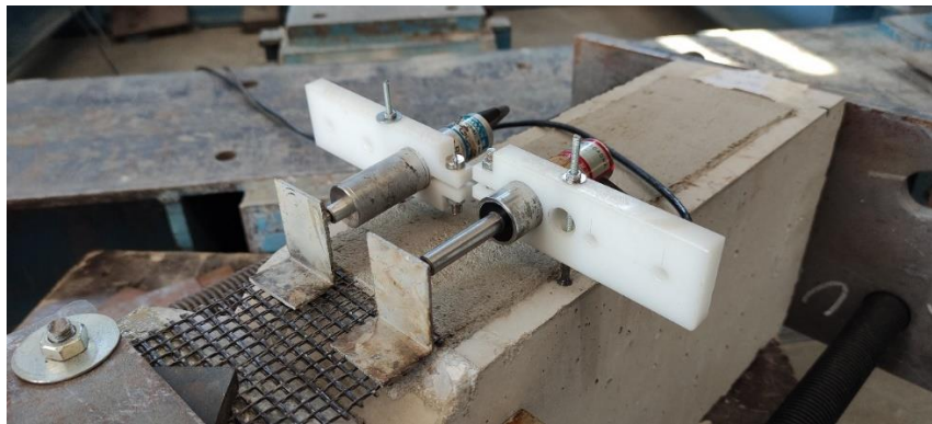
Σχήμα 4.15 Τοποθέτηση των LVDT's α) και β).
