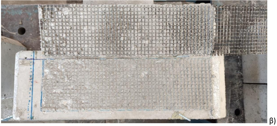
Σχήμα 4.27 Διαστρωματική αποκόλληση μεταξύ πλέγματος και κονιάματος για το δοκίμιο L300_2_2 α) και β).
