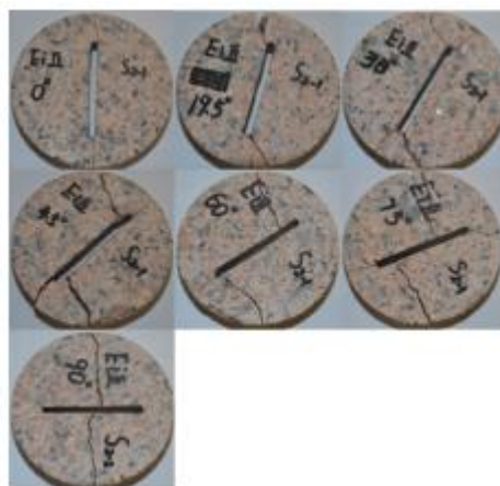
Σχήμα 4.11: Παρατηρούμενο μοτίβο θραύσης σε δίσκους πετρώματος με ρωγμή που δοκιμάστηκαν σε μονοαξονική θλίψη, αλλά με διαφορετικό προσανατολισμό (δοκιμές έμμεσου εφελκυσμού), (Konietzky, 2016).
