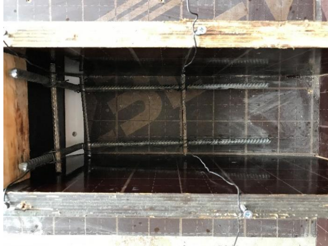
Σχήμα 3.3 Απεικόνιση καλουπιού με σπλισμό δοκιμίου.
