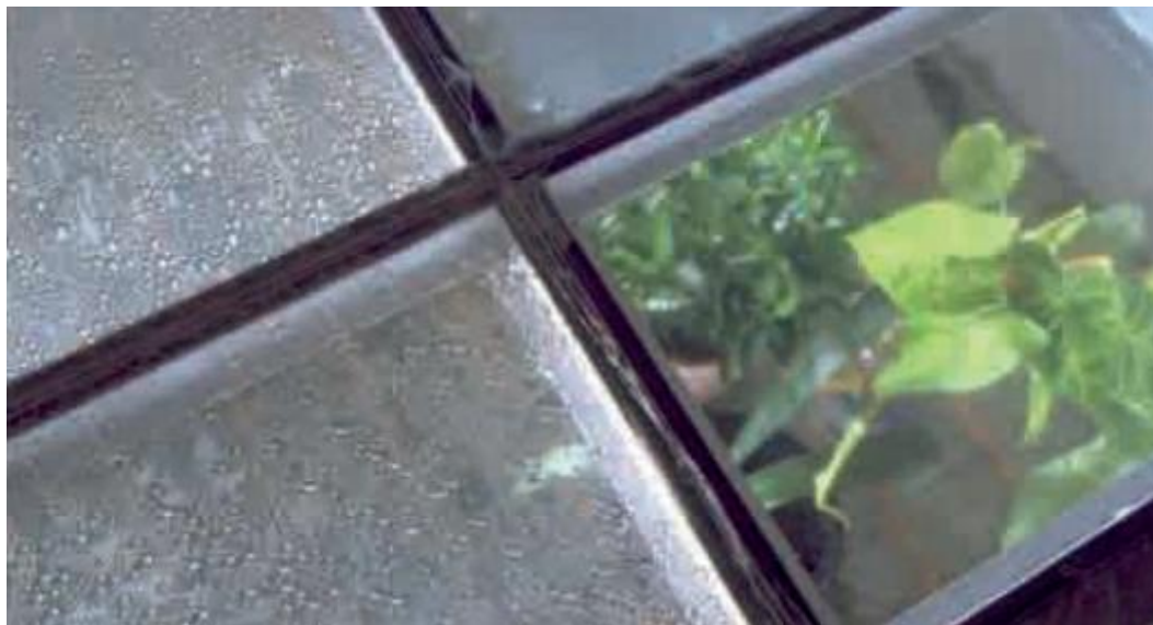
Εικόνα 2.2 Συμβατική μεμβράνη (αριστερά) έναντι μεμβράνης με πρόσθετα κατά των σταγονιδίων (δεξιά) (Montero et al., 2013)
