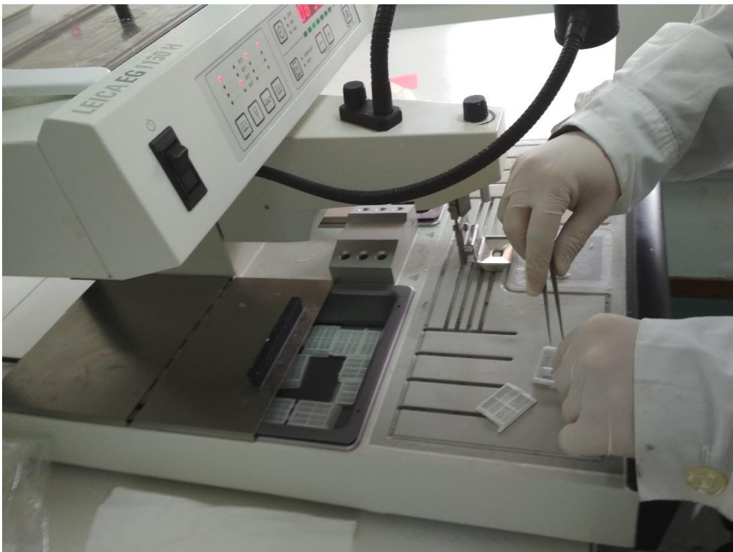
Εικόνα 2.4.1 Μηχάνημα σκλήνωσης, διαδικασία εμφάνισης με παραφίνη. (Προσωπικό αρχείο, Μαμάη Πολυξένη, 2021).
