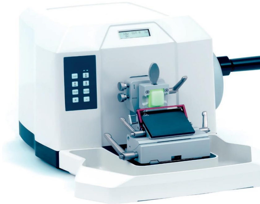
Εικόνα 2.1.6 Η παλινδρομική μικροτόμος με τον χειροκίνητο μοχλό στα δεξιά. (Solmedia, 2022)
