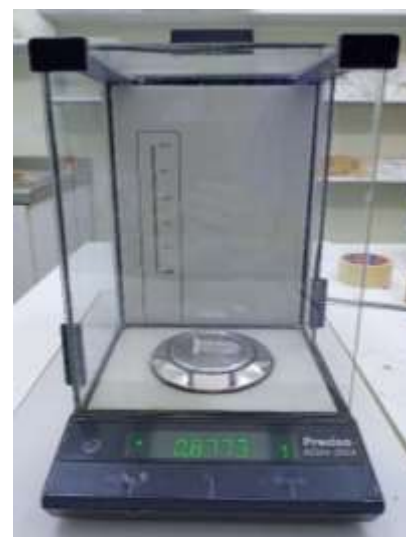
Εικόνα 19: Ζυγαριά ακριβείας για την καταγραφή του βάρους των ενήλικων κουνουπιών.
