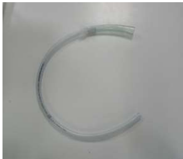
Εικόνα 12: Αναρροφητήρας για μεταφορά και μεταχείριση ενήλικων κουνουπιών
