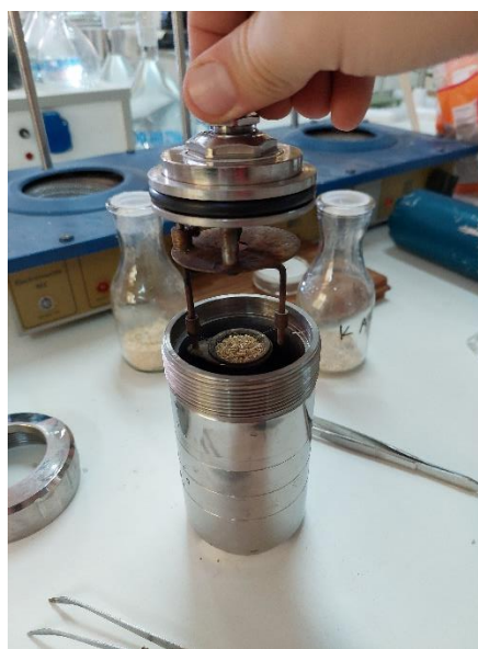
Εικόνα 34: Το σύρμα που εισέρχεται στο δείγμα (δεξιά) και η τοποθέτηση του δείγματος εντός της βομβίδας (αριστερά).
