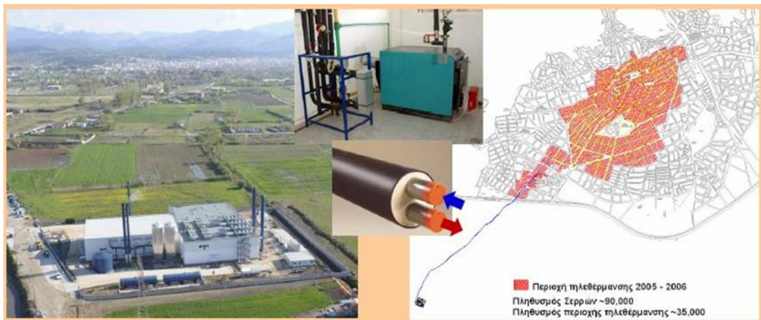
Εικόνα 15: Κάτοψη εγκατάστασης ΣΗΘ, καταναλωτές και δίκτυο
