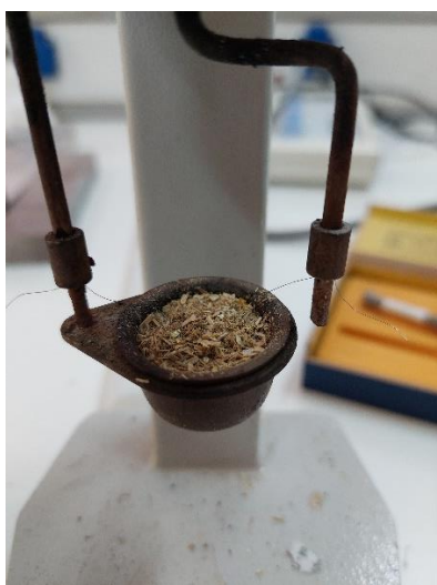
Εικόνα 34: Το σύρμα που εισέρχεται στο δείγμα (δεξιά) και η τοποθέτηση του δείγματος εντός της βομβίδας (αριστερά).
