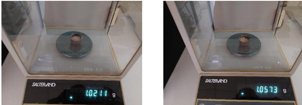
Εικόνα 31: Τα δείγματα πριν τοποθετηθούν στη βομβίδα.
