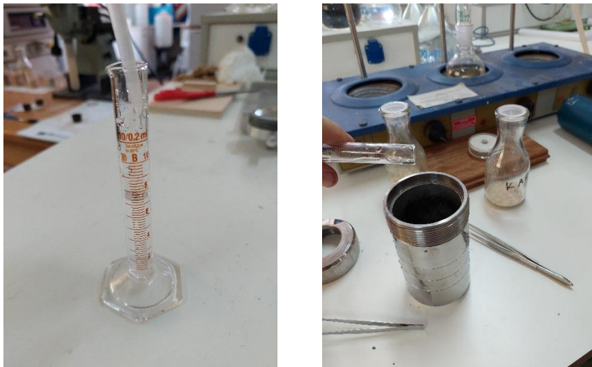
Εικόνα 32: Πλήρωση της βομβίδας με 10ml απεσταγμένο νερό.
