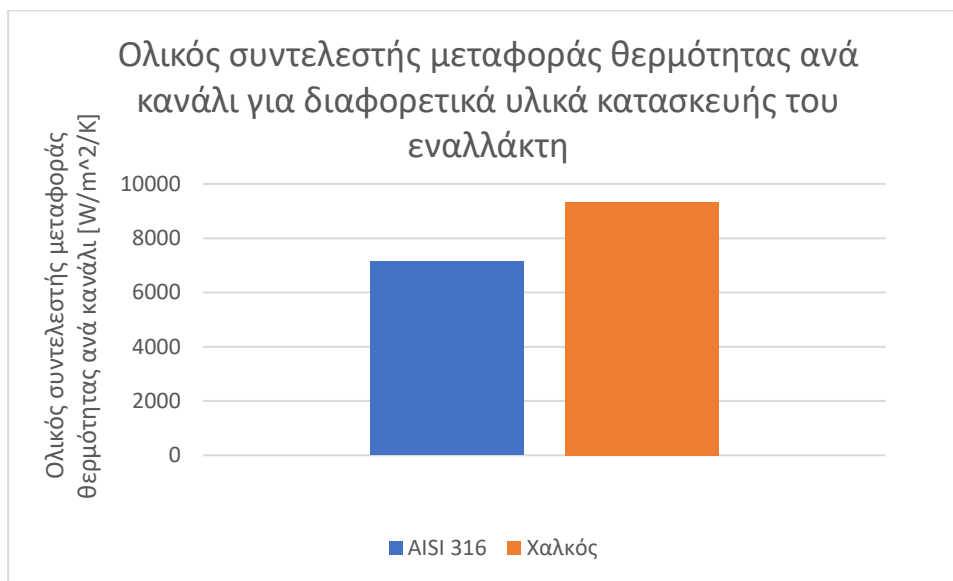
Σχήμα 5-15 Ολικός συντελεστής μεταφοράς θερμότητας για διαφορετικά υλικά κατασκευής του εναλλάκτη
