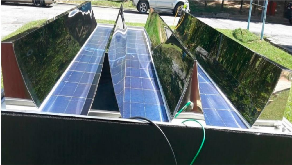
Εικόνα 2.3: Σύνθετοι παραβολικοί συλλέκτες (CPC) με φωτοβολταϊκό δέκτη. [20]
