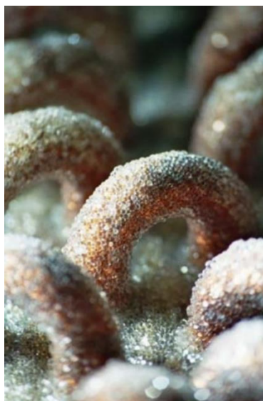
Εικόνα 2.5: Εναλλάκτης θερμότητας αυλών - πτερυγίων επικαλυμμένος με silica gel. [27]
