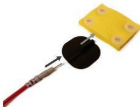
Εικόνα 1.12 Μονάδα ηλεκτροδίου-σφουγγαριού της συσκευής tDCS (13).
