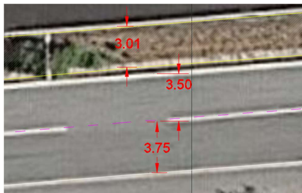
Σχήμα 1.3: Πλάτη λωρίδας της οδού
