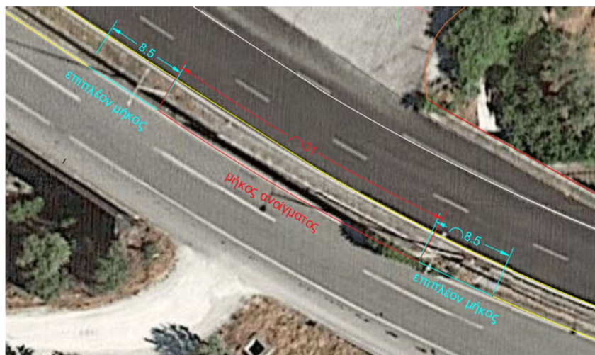
Σχήμα 4.1: Μήκη εφαρμογής στηθαίου NJ στην γέφυρα Χ.Θ. 3+457
