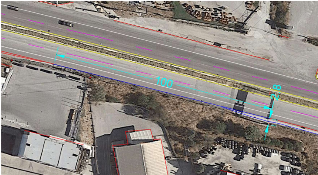
Σχήμα 3.13: Βάση γέφυρας σήμανσης πλησίον παρόδιας πρόσβασης Χ.Θ.7+52
