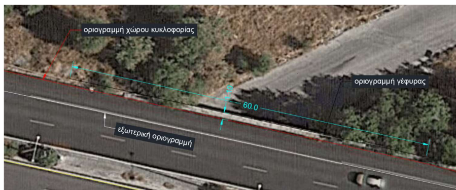
Σχήμα 3.4: Οριοθέτηση και άνοιγμα της γέφυρας στην Χ.Θ. 1+756
