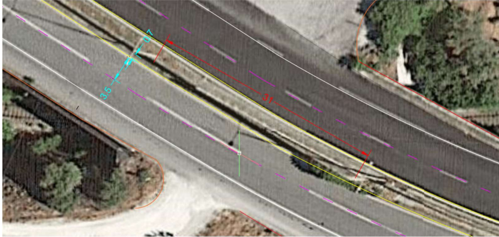
Σχήμα 3.2: Απεικόνιση της έλλειψης πλευρικού χώρου της γέφυρας στην Χ.Θ. 3+457 σε περιβάλλον AutoCAD
