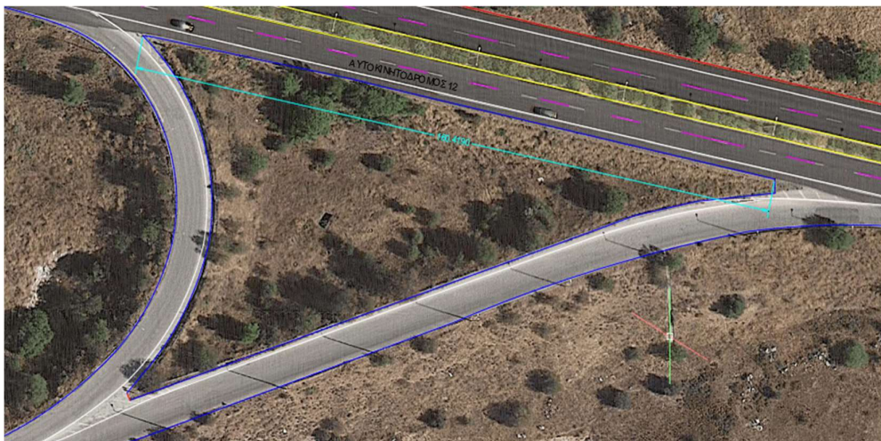
Σχήμα 4.10: Σχέδιο τοποθέτησης χαλύβδινου Σ.Α. N2/W7 στην νησίδα
