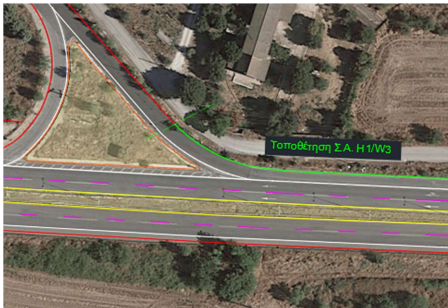
Σχήμα 4.6: Απεικόνιση του μήκους εγκατάστασης του Σ.Α. Η1/W3
