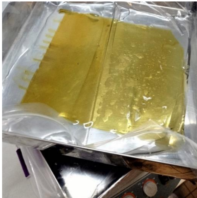
Εικόνα 22: Τοποθέτηση του πηκτώματος στον αναδευτήρα ύστερα από την προσθήκη του τρίτου διαλύματος έως την εμφάνιση των ζωνών.
