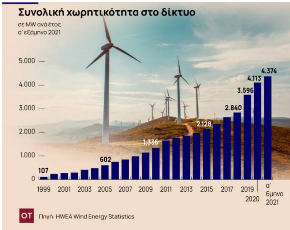
Εικόνα 2. Συνολική εγκατεστημένη ισχύ στην Ελλάδα μέχρι και το πρώτο εξάμηνο του 2021. Πηγή: www.eletaen.gr/wp-content , 2021
