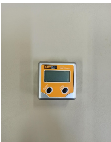
Εικόνα 4.8. Ψηφιακό ινκλινόμετρο CMT
