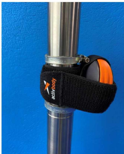
Εικόνα 3.11. Δυναμόμετρο σταθεροποιημένο στο στύλο
