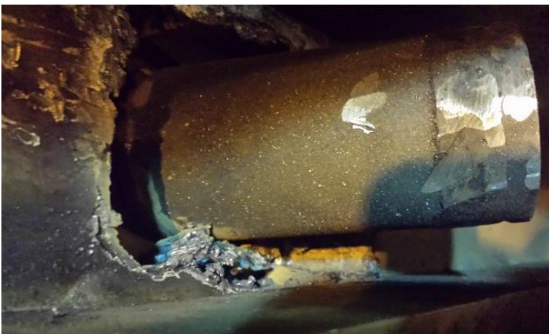
Εικόνα 2.8.3 – Η διάμετρος οπής σε σχέση με τη διάμετρο περόνης
