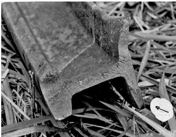
Εικόνα 2.1.3 – Η διατομή στο σημείο C (χαρακτηριστικά όλκιμης θραύσης)
