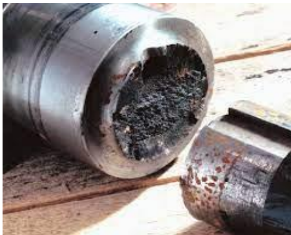
Εικόνα 12 Θραύση του άξονα αμαξοστοιχίας λόγω κόπωσης ( https://faculty.up.edu ).
