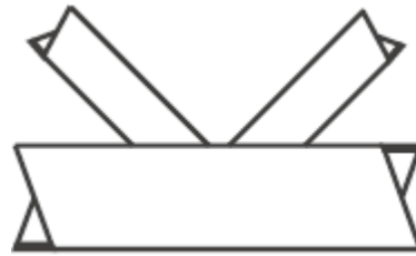
Εικόνα 1.6 Συνδεσμολογία ορθογωνικών διατομών τύπου K (gap).
