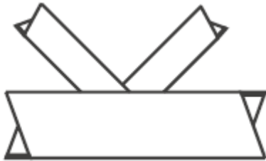
Εικόνα 1.5 Συνδεσμολογία ορθογωνικών διατομών τύπου K (overlap).
