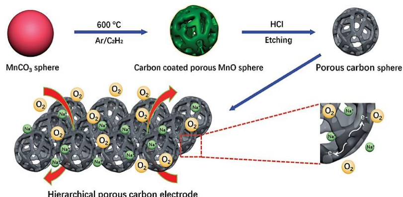
Σχήμα 74. Σχηματική απεικόνιση της διαδικασίας σύνθεσης των PCS και του ηλεκτροδίου καθόδου κατασκευασμένο από PCS [310].
