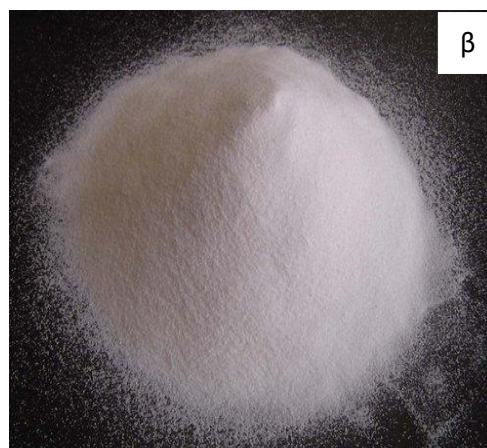
Σχήμα 3.1 α) Φωτογραφία SEM που παρουσιάζει την μικροδομή της μετακαολίνης, (Veģere et. al., 2019) β) Πούδρα μετακαολίνης.
